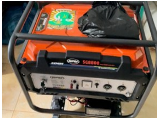
a. Generator Listrik 5.5 kW Tenaga Gasoline
