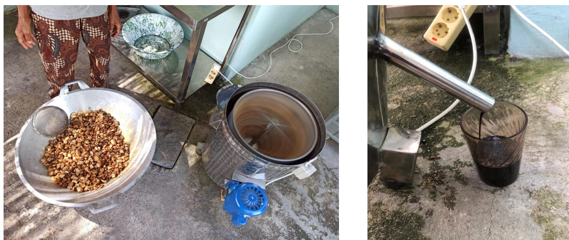
Gambar 2. Proses Penirisan Minyak Kerupuk Kulit Menggunakan Mesin Spinner
