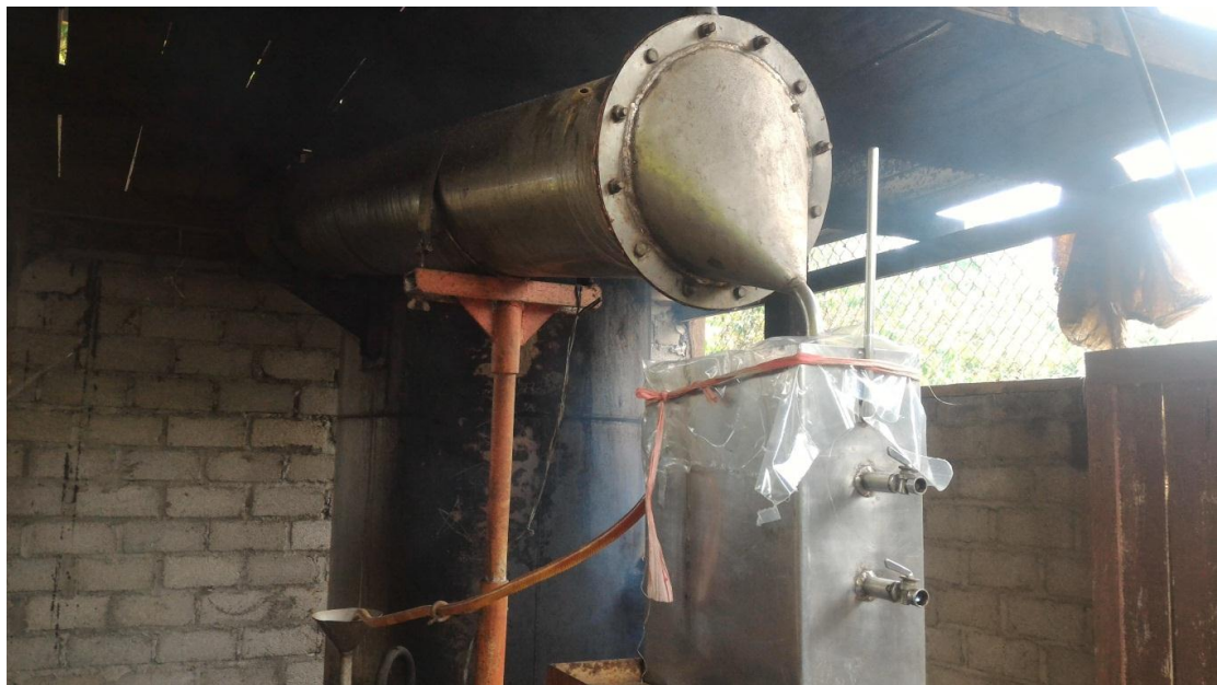
Gambar 2. Bentuk Instalasi Penyulingan Minyak Atsiri Dari Tanaman Yang Dimiliki Balitro, Diperlihatkan ke Petani
